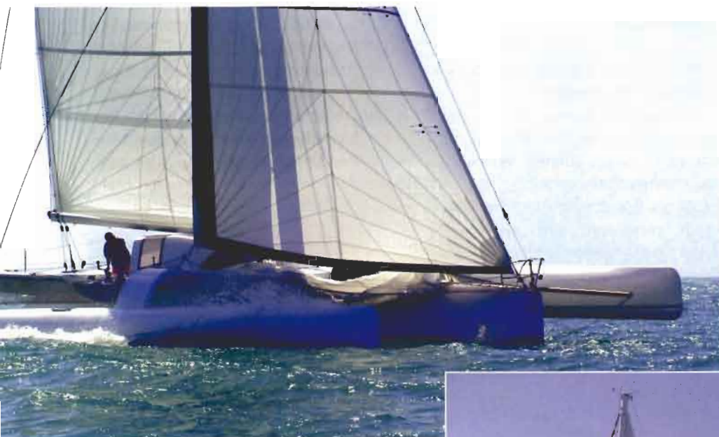
Arbeitsfeld für die Superyachtexperten: triradial geschnittene High-Tech-Segel für 60-Fuß-ORMA-Trimaran und Foliensegel für die Solaris 72.
