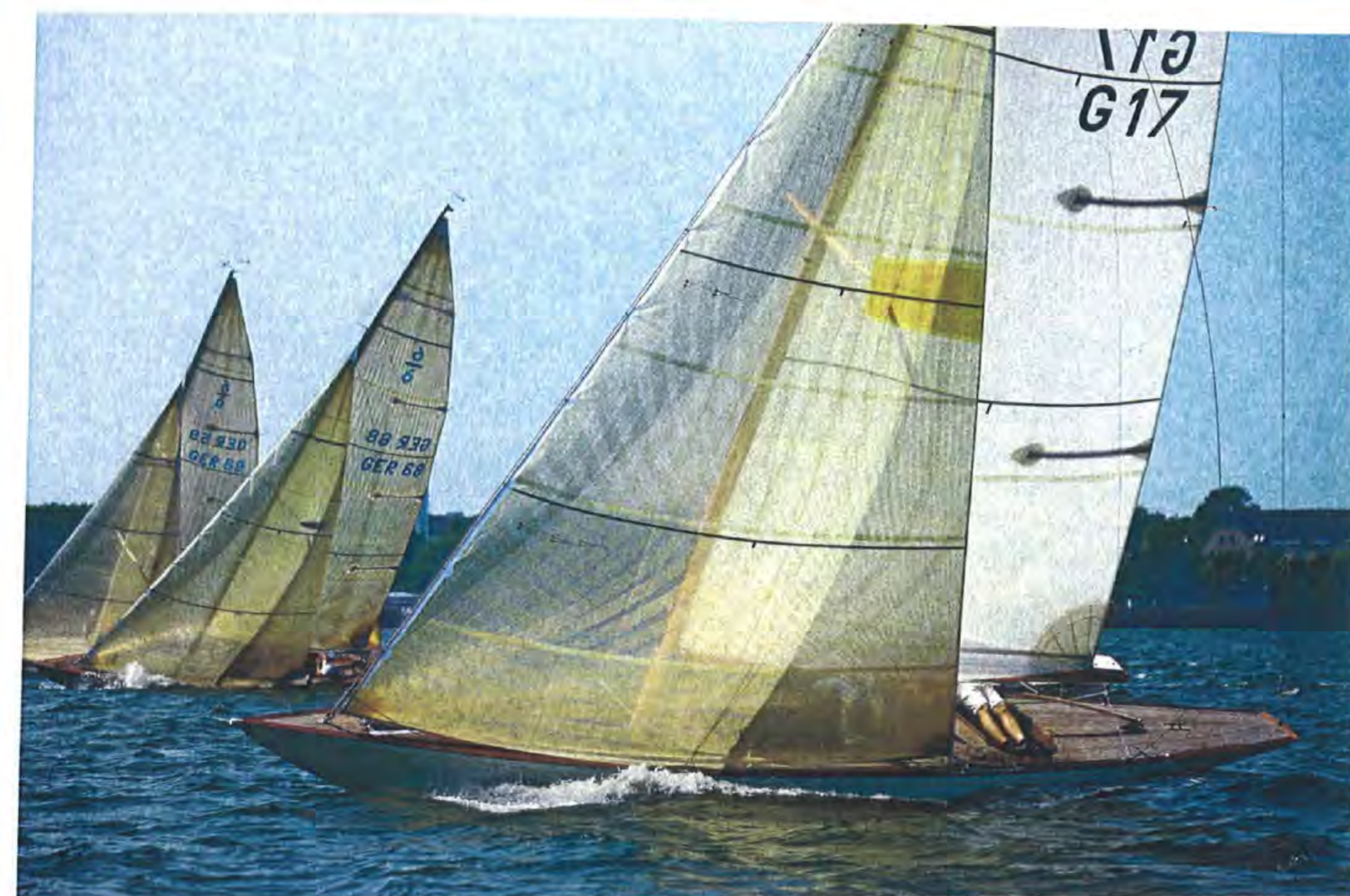
Hightech auf dem Vormarsch: Membransegel (o.) bieten perfekten Stand, aber nicht die gleiche Langlebigkeit wie gewebte Tücher (u.)
